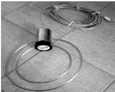
Σχήμα 3. Η συσκευή παρακολούθησης της εδαφικής υγρασίας VIRRIB.
