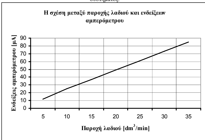
Σχήμα 2. Το διάγραμμα της σχέσεως μεταξύ παροχής λαδιού και ενδείξεων αμπερόμετρου.
