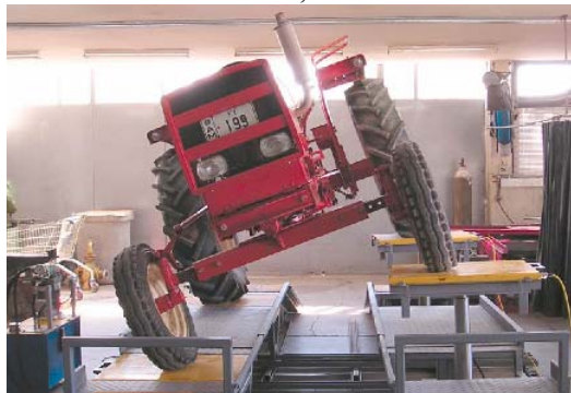
Σχήμα 4. Ο γεωργικός ελκυστήρας επάνω στην τράπεζα δοκιμών για καθορισμό των αντιδράσεων και των γωνιών για δεξιά πορεία.
