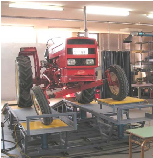
Σχήμα 5. Μεταβολή της οριζοντιότητας του πρόσθιου αριστερού τροχού.
