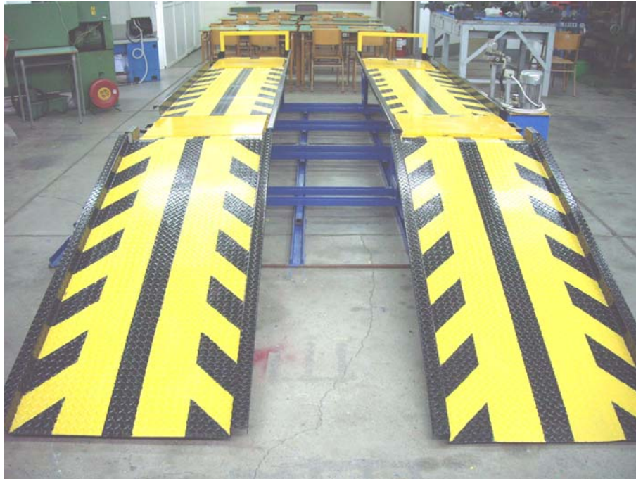
Σχήμα 2. Γενική όψη της ρυθμιζόμενης τράπεζας δοκιμών με τις αυτόματες ηλεκτρονικές μονάδες ζύγισης.
