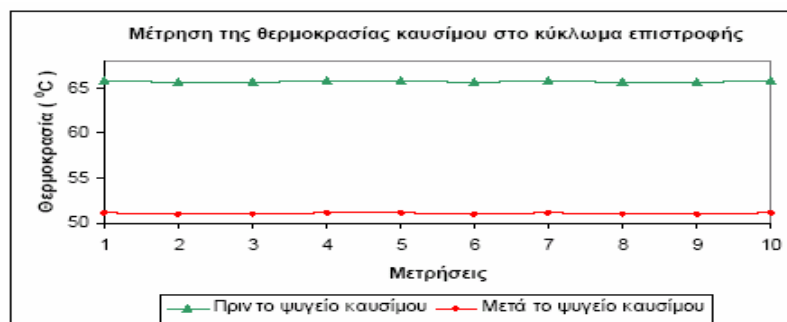
Σχήμα 7. Μέτρηση της θερμοκρασίας καυσίμου στο κύκλωμα επιστροφής.
