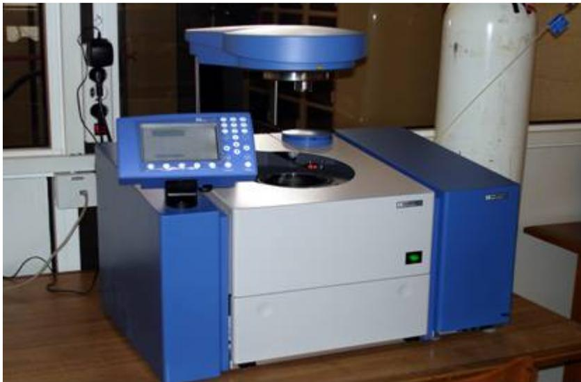
**Figure 2.** Bomb calorimeter C5000 IKA®-Werke
